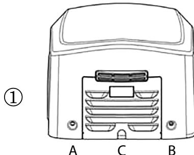
Pour enlever le couvercle frontal, se placer face à l'appareil et tirer vers soi en exerçant une légère pression sur les côtés comme indiqué dans la figure suivante:
