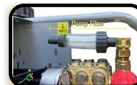
Le filtre de la pompe protège le moteur de la pompe et les autres composants internes des dommages causés par la saleté, le sable ou d'autres particules. Cela permet à la pompe de durer plus longtemps et réduit le risque de dysfonctionnement.
